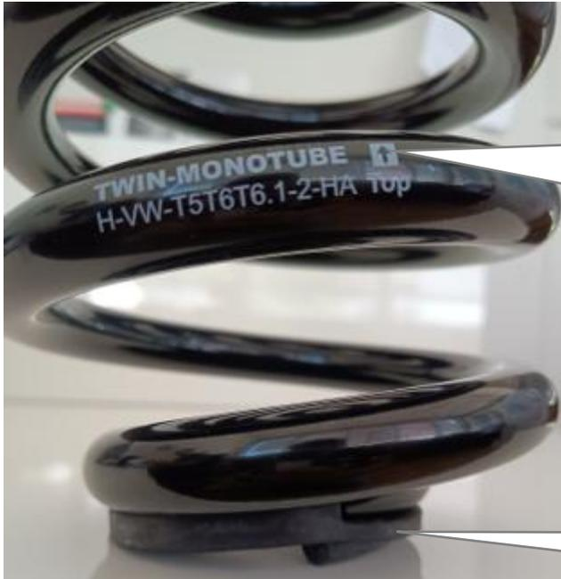
Der **Richtungspfeil** zeigt das obere und untere Ende der Feder und somit die **Einbaurichtung**
