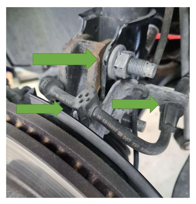
Die Zuleitungen und Kabel aus den Halterungen entfernen. Die Muttern der Federbeinbefestigung abdrehen, die Schrauben stecken lassen. Beginnen Sie mit dem Ausbau von oben.
