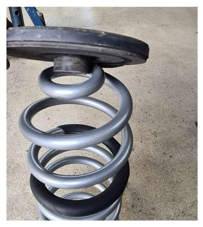
Original Feder gegen Eibach Feder austauschen. Unten muss die Feder richtig an den dafür vorgesehenen Anschlägen anliegen. Die obere und untere Federauflage sind Originalteile. Diese müssen auf Verschleiß geprüft werden und sind bei Bedarf zu ersetzen.
