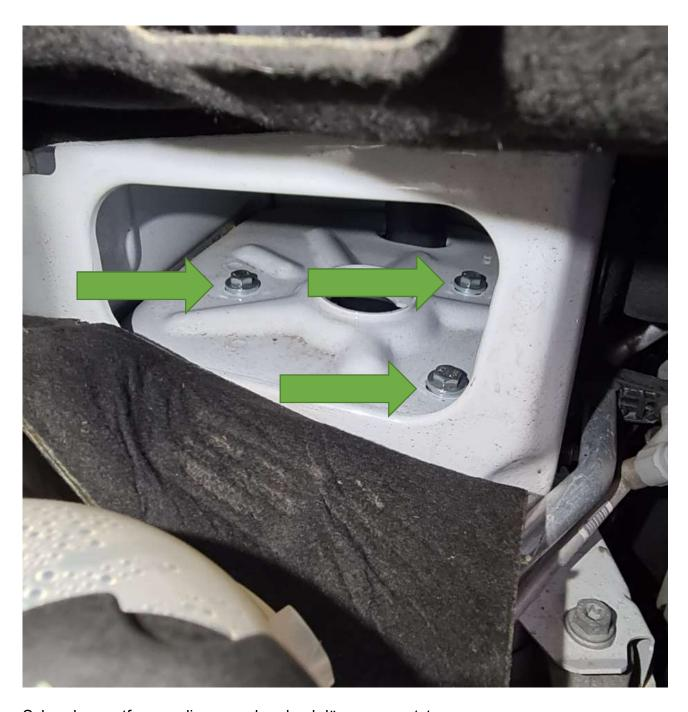
Schrauben entfernen, diese werden durch längere ersetzt.
