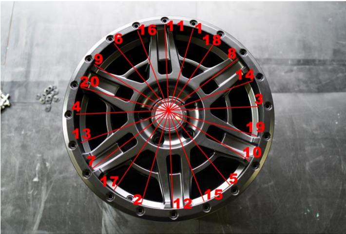
Schrauben nach Anzugschema (siehe Bild oben) mit 12 Nm anziehen.
